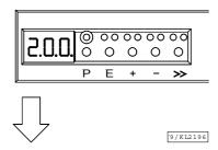
**2.** Seleccionar el próximo parámetro mediante la tecla +.
