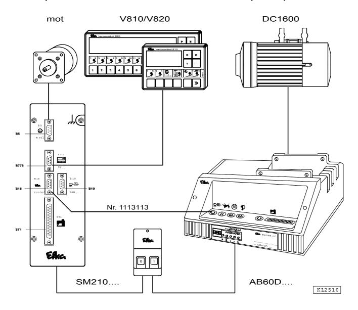
El control AB60D.... (B18) y el mando del motor paso a paso SM210A.... (B18) son conectados mediante el cable de adaptación no. 1113113.
