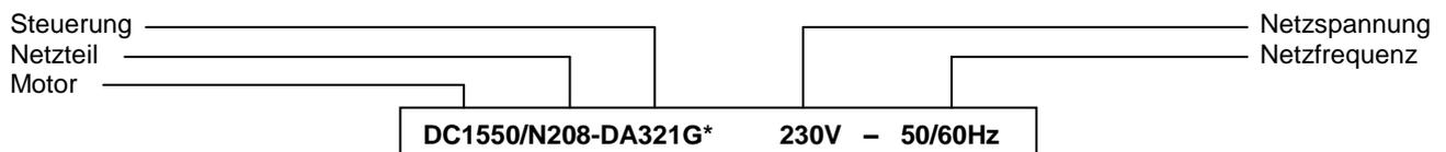
\*) Zusätzlich zur Typbezeichnung gibt das Typenschild der Steuerung Auskunft über deren Entwicklungsstand (z. B. DA3212G...Y1) und die Programmnummer (z. B. DA321G5321..). Die Angabe des Entwicklungsstandes ist jedoch nur bei technischen Rückfragen oder im Reparaturfall erforderlich.
