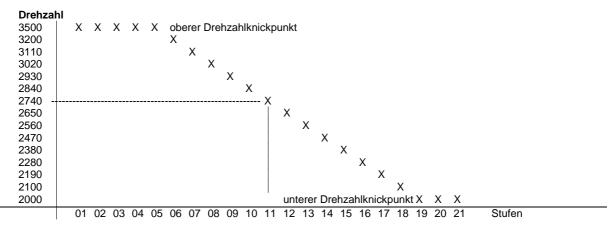
Anzeigebeispiel des Parameters 182 am Bedienteil V820:
