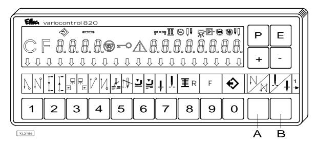
Das Bedienteil V820 wird bei Auslieferung mit dem Einschubstreifen **Nr. 1** über den Tasten bestückt. Bei anderen Funktionen kann dieser durch einen der beim Bedienteil beigelegten Einschubstreifen gewechselt werden. Dazu muss auch der Parameter **292** umgestellt werden. Siehe auch Betriebsanleitung **V810** / **V820**!
