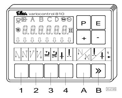
Das Bedienteil V810 wird bei Auslieferung mit dem Einschubstreifen **Nr. 1** über den Tasten bestückt. Bei anderen Funktionen kann dieser durch einen der beim Bedienteil beigelegten Einschubstreifen gewechselt werden. Dazu muss auch der Parameter **291** umgestellt werden. Siehe auch in der Betriebsanleitung **V810 / V820**!
