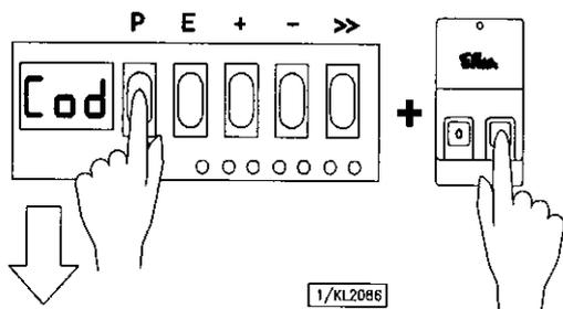
5. + Taste bzw. - Taste zur Auswahl der zweiten Ziffer betätigen
