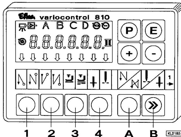
Das Bedienteil V810 wird bei Auslieferung mit dem Einschubstreifen Nr. 1 über den Tasten bestückt. Bei anderen Funktionen kann dieser durch einen der beim Bedienteil beigelegten Einschubstreifen gewechselt werden. Dazu muß auch der Parameter 291 umgestellt werden. Siehe auch Betriebsanleitung V810 / V820!
