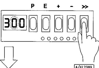
8. E-Taste drücken, Parameter wird angezeigt. Punkte zwischen den Ziffern im Display kennzeichnen, daß eine Parameternummer angezeigt wird.
