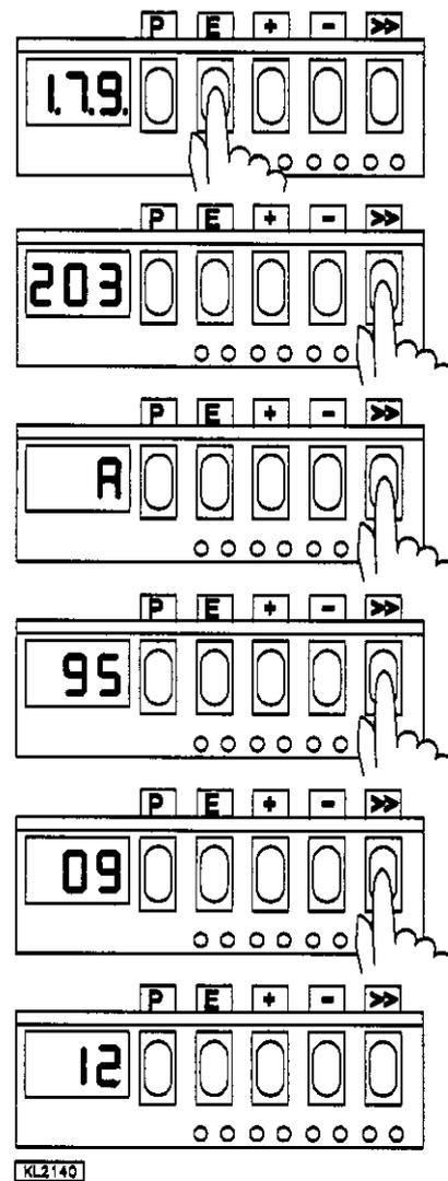
Bei zweimaliger Betätigung der P-Taste wird die Routine verlassen und der Antrieb ist für den Nähvorgang wieder bereit. Bei Betätigen der E-Taste wird ebenfalls die Routine verlassen und die nächste Parameternummer angezeigt.
