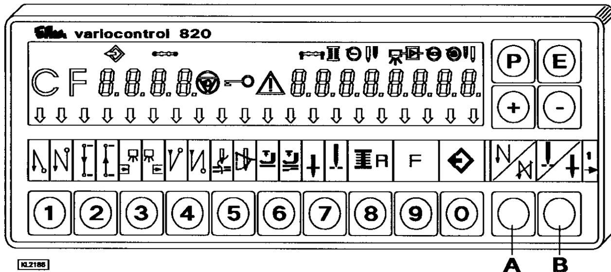
Das Bedienteil V820 wird bei Auslieferung mit dem Einschubstreifen Nr. 1 über den Tasten bestückt. Bei anderen Funktionen kann dieser durch einen der beim Bedienteil beigelegten Einschubstreifen gewechselt werden. Dazu muß auch der Parameter 292 umgestellt werden. Siehe auch Betriebsanleitung V810 / V820!
