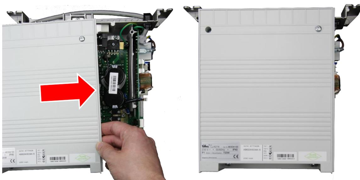
**Hinweis:** Achten Sie bei der Montage des seitlichen Gehäusedeckels darauf, dass die Netzfilterplatine richtig in der Haltenut sitzt!
