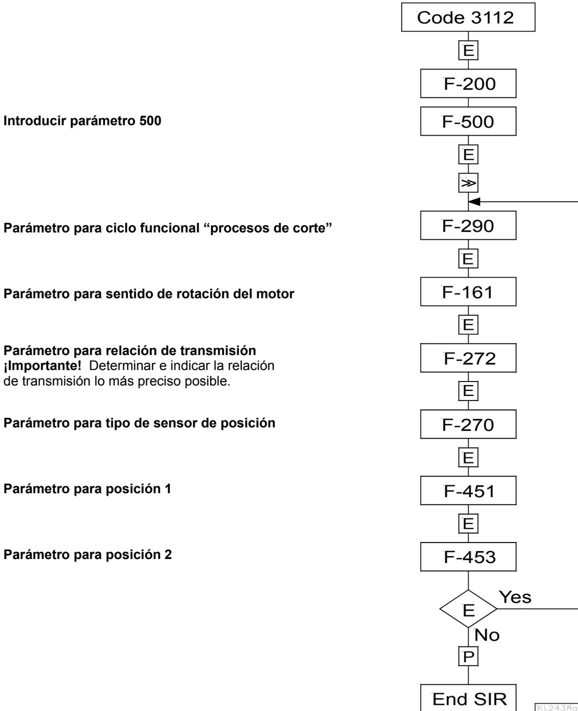
Los valores pueden ser variados mediante la tecla +/- . Cuando se visualiza el parámetro en el programador V810, presionar la tecla E otra vez para visualizar el valor.
