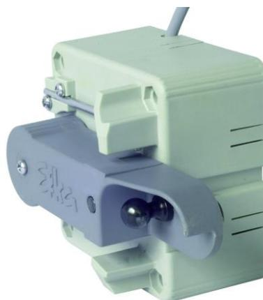
Il trasduttore di valori analogico EB401 è un attuatore che, interagendo con un pedale applicato alla macchina, controlla le funzioni operative (cucitura) a diverse velocità, l'alzapiedino e il taglio dei fili.
