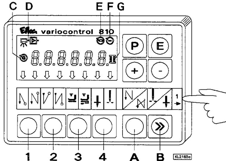
Utilizar a tira de inserir cujos símbolos correspondem ao tipo de dispositivo de comando. Se for necessário, trocar a tira de inserir padrão do painel de comando utilizando a ferramenta adequada (p.ex. pinças) e introduzir a tira apropriada. Ver anexo A.
